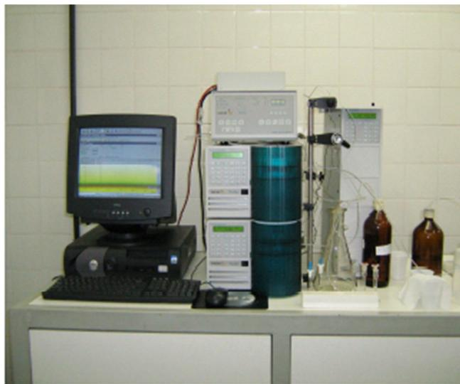
Figura 3.1 – Equipamento de análise cromatográfica líquida com detecção por índice de refração utilizado neste trabalho
