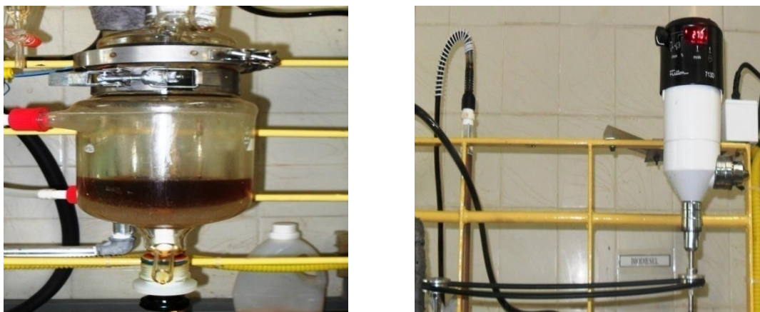
Figura 20 – Reator e agitador mecânico com controle de velocidade de rotação.
