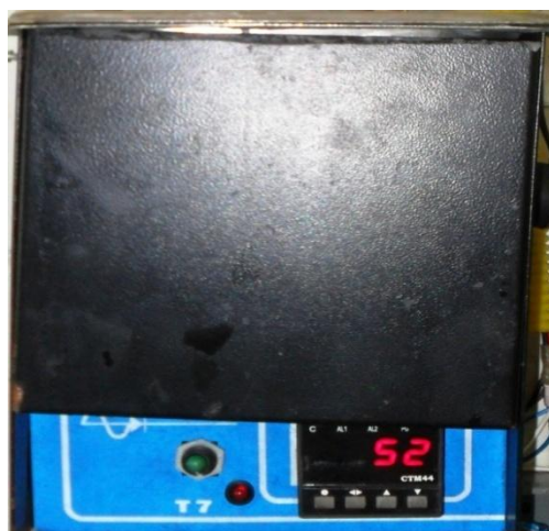
Figura 21 – Controlador de temperatura do reator de transesterificação.
