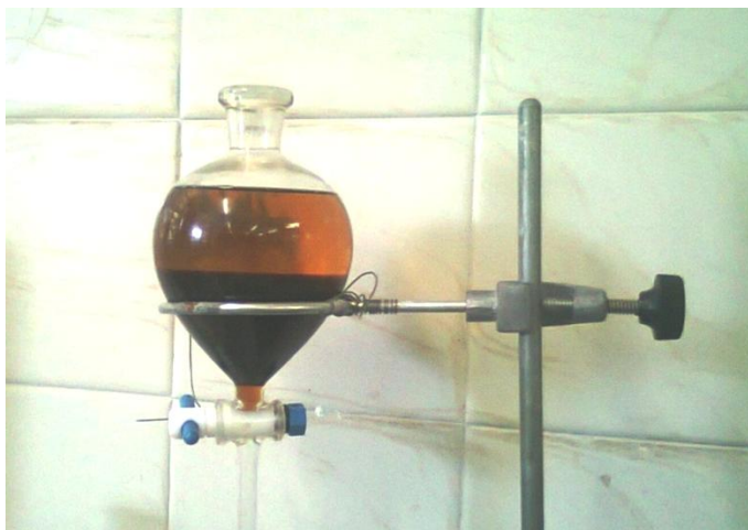
Figura 22 – Separação da mistura por decantação. Duas fases biodiesel e glicerina.
