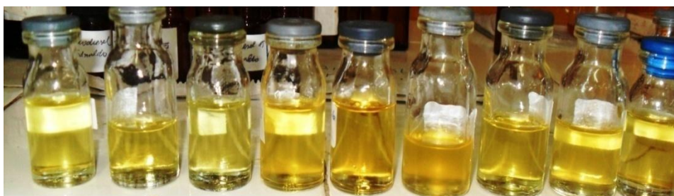
Figura 24 – Amostras de biodiesel preparadas para análise cromatográfica.
