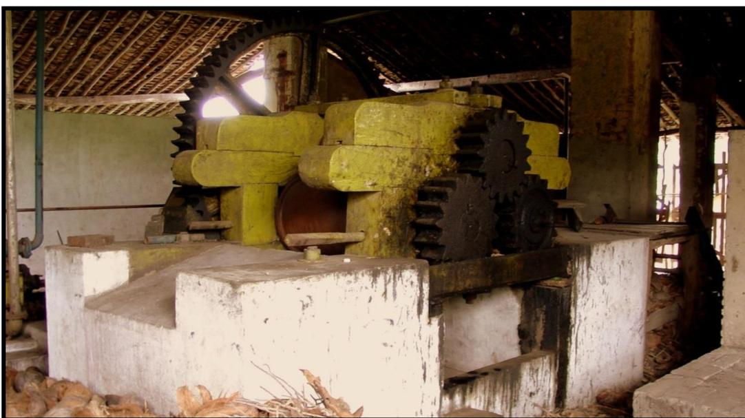
Figura. 7 - Máquina a vapor do engenho Estaleiro. Fonte: Acervo do NEPA
