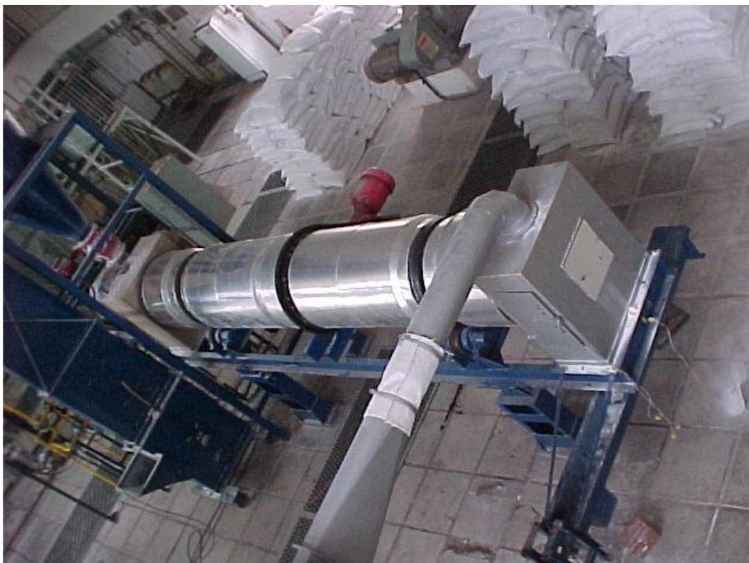
Figura 8: Forno rotativo piloto para calcinação da gipsita – DEQ/UFPE.
