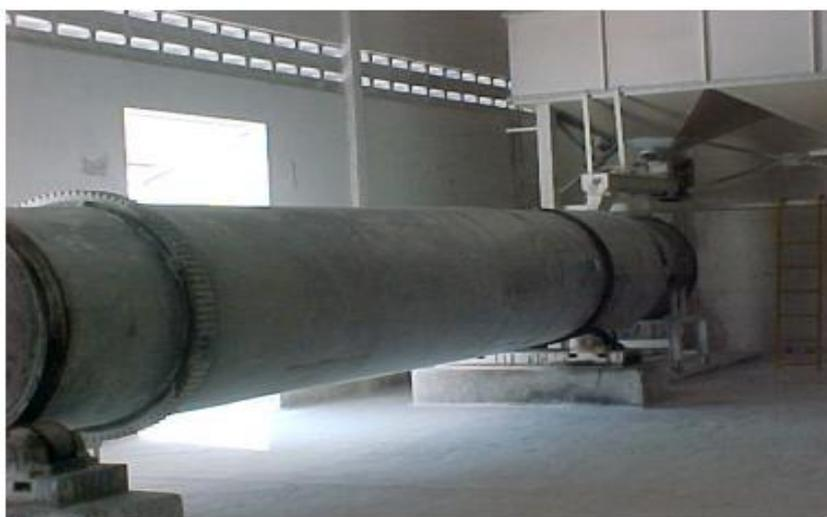
Figura 3: Forno rotativo de contato direto utilizando BPF como combustível.
