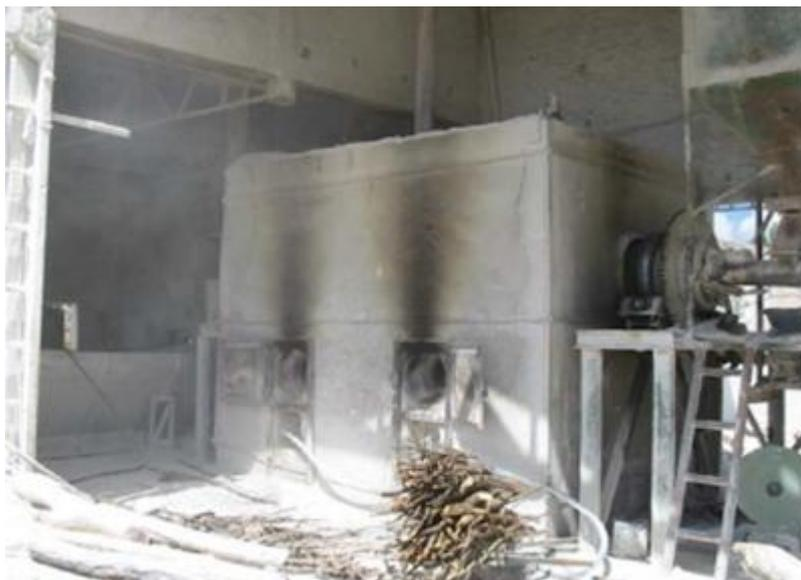
Figura 2: Forno marmita rotativa utilizando lenha como combustível.
