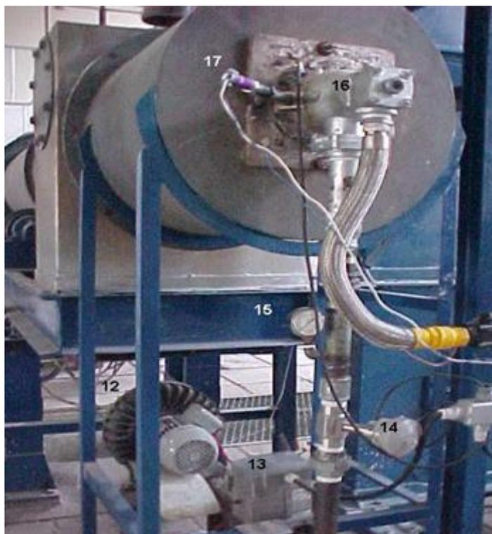
Figura 9 - Sistema de alimentação do ar de combustão e queimador.
