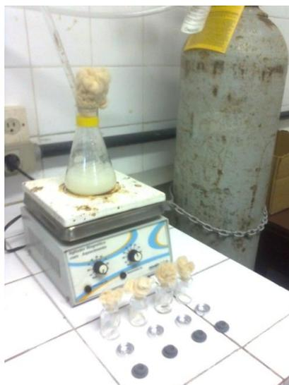
**Figura 8** – Preparação de meio de cultura utilizando chapa aquecedora e gás nitrogênio.
