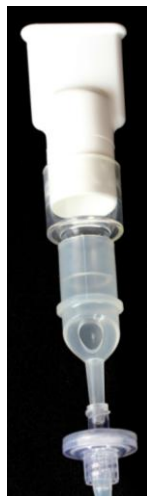
Figura 8: Imagem da montagem do bucal científico com o filtro barreira isolador de pressão. (Fonte: Manual do usuário Manovacúmetro Digital MVD ® 300 - Rev. I)
