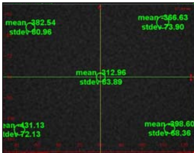
Figura 25 – Imagem axial de simulador cilíndrico uniforme, mostrando o posicionamento de cinco ROIs circulares (e os números CT com desvio padrão de cada uma, em HU), utilizando o software do tomógrafo i-CAT classic, para a avaliação da uniformidade da imagem.
