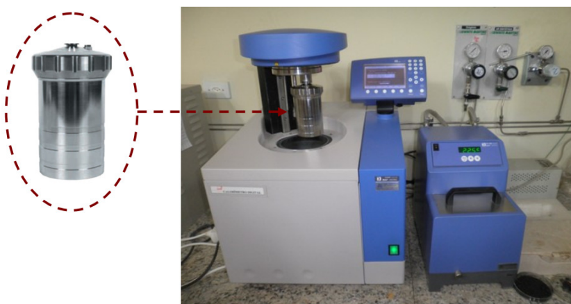
Figura 27 – Calorímetro Digital Automático IKA-WERKE, modelo C2000, com detalhe do vaso de decomposição.
