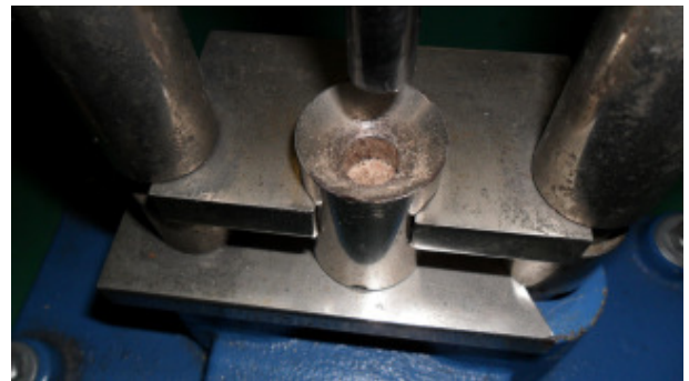
Figura 22 – Biomassa no molde do pellet (estágio pré-compactação).
