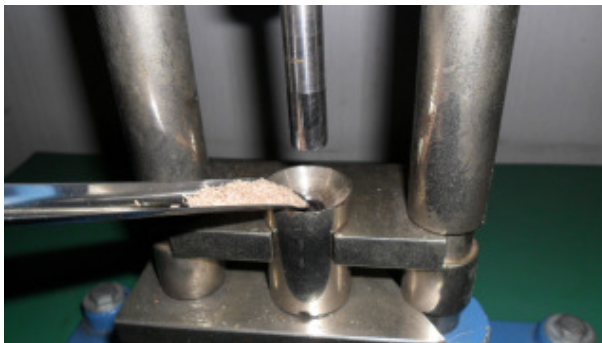
Figura 21 – Deposição da biomassa tratada na prensa manual.
