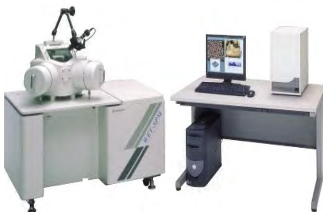
Figura 3.10: AFM Shimadzu modelo SPM9600 com câmara ambiente acoplada.
