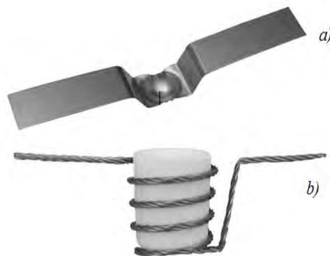
Figura 3.1: Cadinhos utilizados nos processos e evaporação térmica (a) Cadinho de Tungstênio utilizado para evaporar ouro e alumínio. (b) Cadinho utilizado para deposição dos filmes de ZnO.
