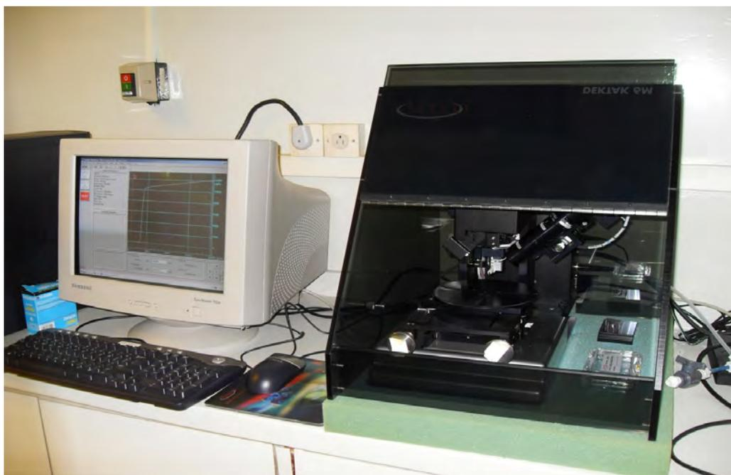
Figura 3.9: Perfilômetro DEKTAK 6M da Veeco Instruments Inc..
