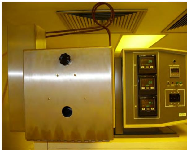
Figura 3.2: Forno Termo-Resistivo THERMCO MB80.
