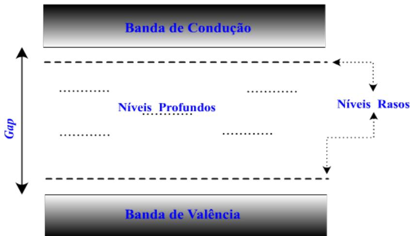
Figura 2.12: Diagrama esquemático mostrando os níveis profundos e rasos no interior do *gap* semicondutor.
